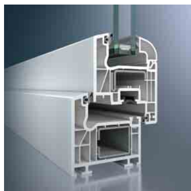
Hohe Basissicherheit: Die Bautiefe von 70 mm und weit innen liegende Beschlüge entziehen die Verschlusselemente dem Angriff der Einbrecher.
